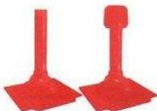
Для вывода вентканалов канализации на кровлю существуют неизолированные патрубки оснащенные регулировкой угла наклона и основанием. Диаметр трубы 110 мм. Для вентканалов кухонных воздухоочистителей поставляются теплоизолированные патрубки диаметром 125 мм.
