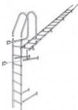
Прикрепите к лестнице верхние дуги. Верхняя ступенька лестницы должна находиться примерно на 10 см выше карниза крыши. Верхние дуги крепят либо к кровле, либо к кровельной лестнице. На лестницу навесьте опоры, которые затем надежно прикрепите к стене.
