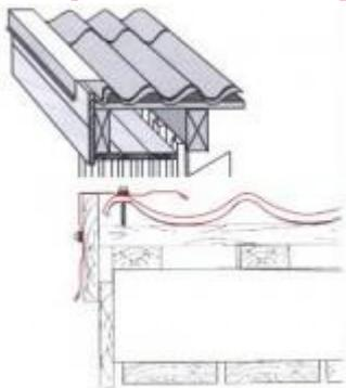
Торцевая планка должна заходить, по крайней мере, на гребень первой волны профиля. В случае, если край кровельного листа не совпадает с краем карниза, лист необходимо обрезать либо продолжить. Торцевую планку крепят к кровельному листу винтами либо потайными заклепками примерно через каждый метр. Нахлест деталей карниза должен составлять не менее 100 мм.
