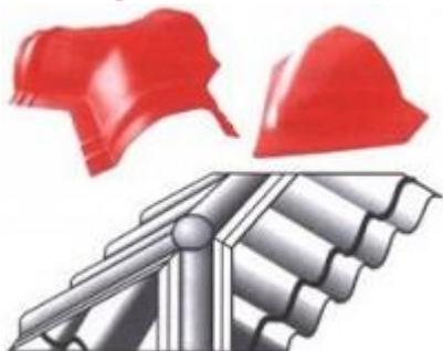
На шатровых (вальмовых) стыках используют коньковую планку, которая устанавливается также как и на конек. С помощью детали Y-образной формы и торцевых заглушек достигается лучший визуальный эффект и герметичность. Между деталями конька и кровельным листом укладывают ендовую уплотнительную ленту, с наклонным рисунком уплотнителя. Существует как правосторонняя, так и левосторонняя лента.
